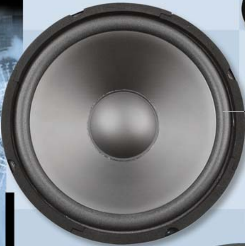
PP 135 WOOFER 100W Per toni medi con diametro 13cm in polipropilene bordato in neoprene. Potenza massima: 100 W Impedenza: 8 Ohm Sensibilità: 90db Banda passante: 65Hz-7KHz Chassis aperto
