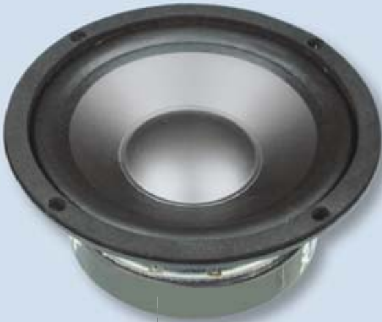
PP 135 WOOFER 100W Per toni medi con diametro 13cm in polipropilene bordato in neoprene. Potenza massima: 100 W Impedenza: 8 Ohm Sensibilità: 90db Banda passante: 65Hz-7KHz Chassis aperto
