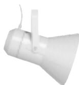
**PH 30 T** Tromba stagna IP 66, profilo circolare in ABS di colore grigio RAL7035, staffa ad U in acciaio inox, potenza 30/15/7,5/3,75 Watt, trasf. 100 V, SPL 1W/1m 110dB, dispersione (-10dB) 1kHz/4kHz 180°/60°, dim.diam 238x287 mm, peso 2,3 Kg
