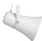
**PH 20 T** Tromba stagna IP 66, profilo circolare in ABS di colore grigio RAL7035, staffa ad U in acciaio inox, potenza 20/10/5/2,5 Watt, trasf. 100 V, temperatura di esercizio max/min 85 C°/-20°C, SPL 1W/1m 108dB, dispersione (-10dB) 1kHz/4kHz 180°/60°, dim.diam 203x254 mm, peso 1,9 Kg
