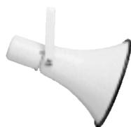
**HD 50 TM** Tromba a profilo circolare in alluminio colore grigio chiaro RAL7035, a tenuta stagna IP55 con staffa ad U, potenza 50 Watt, trasf. 100 V, temperatura di esercizio max/min 85 C°/-20°C, SPL 1W/1m 109dB, dispersione (-10dB) 1kHz/4kHz 80°/60°, dim.diam 430x550 mm, peso 3,8 Kg
