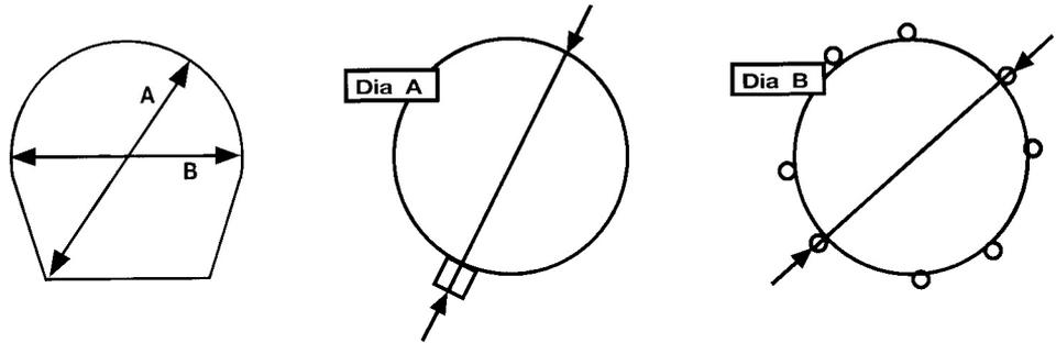
Dia A = Misura della distanza tra la meccanica del rullante ed il blocchetto di tensione della pelle diametralmente opposto
